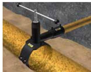
Рис. С.36: Засверливание трубопровода.
