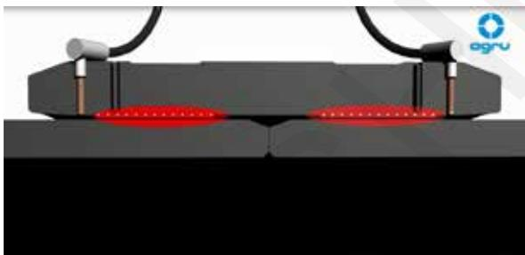
Рис. С.11: Принцип сварки с одной нагревательной спиралью (монофилярная проволока).
