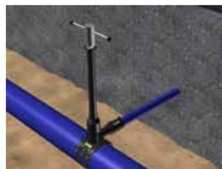
Рис. С.40: Засверливание трубопровода.
