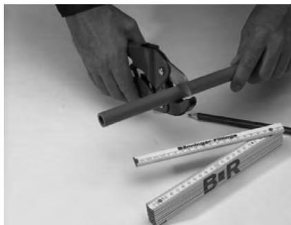
**1.** Отрезать под прямым углом трубу необходимой длины с помощью ножниц для пластмасс или трубореза
