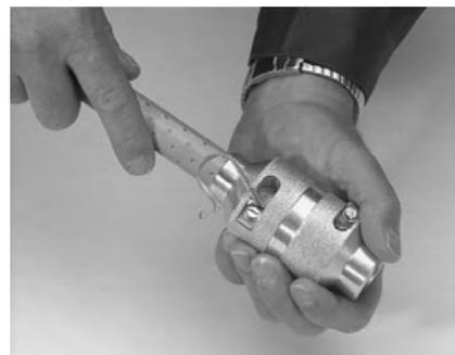
**3.** Вслучае применения труб-штаби алюминиевое покрытие должно быть удалено с помощью зачистного инструмента. Длина зачищаемого участка определяется зачистным инструментом.
