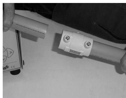
6. Надвинуть муфту на трубу до отметки
