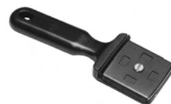
Трубы-штабы имеют с наружной стороны алюминиевое покрытие. Перед свариванием его необходимо удалить в зоне сварки. Каждый зачистной инструмент диаметром до 63 мм предназначен для труб двух разных диаметров. Зачистные инструменты диаметром более 75 мм - для труб только одного размера. Зачистные инструменты диаметром более 50 мм снабжены дополнительными рукоятками.
