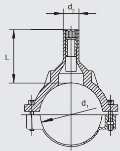
Компактное изделие седловой формы из ПЭ-ВП с открытым нагревательным элементом для оптимальной теплопередачи и выходным патрубком для FRIALEN - муфт типа MB или UB. Врезка без стружки в безнапорном состоянии при помощи интегрированной фрезы.
