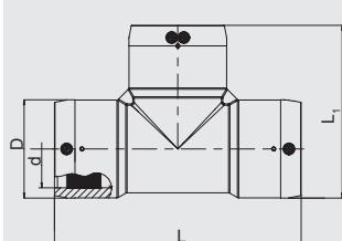
Имеют открытую нагревательную спираль для оптимальной теплопередачи на всех 3 выходах, большую глубину сопряжения, особо широкую зону сварки, холодные зоны по бокам и в центре, предотвращающие вытекание расплавленной массы, не требуют при работе специальных позиционеров и приспособлений. Прямоточная сторона сваривается за одну установку сварочного аппарата, вследствие этого необходимы только 2 сварки.
