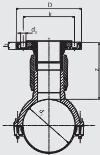
Компактное изделие из ПЭ-ВП. Представляет собой комбинацию из патрубка-накладки FRIALEN и привариваемого фланца тип EFL. Седловина с открытым нагревательным элементом для оптимальной теплопередачи. Врезка производится в безнапорный трубопровод или с использованием обычных для этих целей приспособлений. Фланец изготовлен в соответствии с DIN 2501, ч.1. Мы рекомендуем прокладки GST.
