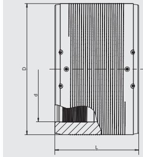
Имеет открытую нагревательную спираль для оптимальной теплопередачи, большую глубину сопряжения, особо широкую зону сварки, холодные зоны по бокам и в центре, предотвращающие вытекание расплавленной массы, не требуют при работе специальных держателей и приспособлений. С жидкостными индикаторами для визуального контроля процесса сварки. Для сварки UB d1000 и более предназначен исключительно сварочный аппарат FRIAMAT XL.
