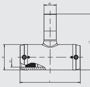
Имеют открытую нагревательную спираль для оптимальной теплопередачи, большую глубину сопряжения, особо широкую зону сварки, холодные зоны по бокам и в центре, предотвращающие вытекание расплавленной массы, не требуют при работе специальных позиционеров и приспособлений. Отводные патрубки SDR11 для приварки муфтами UB/MB.
