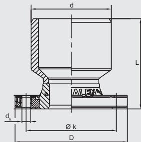
Компактное изделие из ПЭ-ВП, представляющее собой комбинацию ввариваемого фланца EFL и редукции. Специально предназначено для горизонтального соединения фланцевой арматуры к тройникам FRI-ALLEN для редукционного перехода на DN 80 и DN 100. Для вертикального соединения гидрантов в комбинации с нашим отводом 90° и гидрантным под пятником WF 90° d 110 или тройником нужно следить за высотой перекрытия! Без внутреннего грата в месте стыка. Размеры фланца согласно DIN 2501, часть 1.
