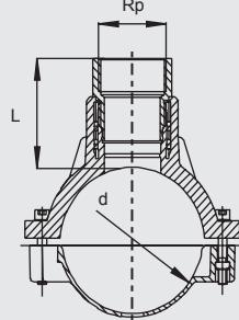
Компактное изделие. Представляет собой седловину из ПЭ-ВП с открытым нагревательным элементом для оптимальной теплопередачи. Переход ПЭ-ВП/красное литье является неразъемным и надежно застопорен в ПЭ-ВП от проворачивания. Служит для присоединения обычных латунных вентилей.
