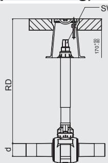
Телескопическая приводная штанга для управления кранами FRIALLEN - KH, KHP, AKHP и AKHP-TL через ковер. В заданной области (RD) бесступенчатая установка по высоте, также в смонтированном состоянии. Самофиксирующийся при любом положении вытяжения. Устойчив к коррозии. Исполнение со шпинделем 14 – специально для домовых подключений.
