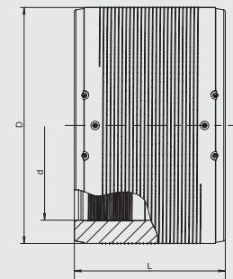
С открытой нагревательной спиралью для оптимальной передачи тепла, большая глубина вставки, широкие сварные зоны, широкие холодные зоны на концах и в середине для удержания давления расплава, монтаж возможен без дополнительных устройств. С индикаторами для визуального контроля сварки.
