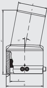
Для универсального и свободного от внутренних напряжений корректирования направления трубопровода, в т.ч. и в стесненных условиях. Достигается максимальная универсальность благодаря вариантам монтажа. Путем комбинации возможно создание отводов 22°, 33° и т.д.
