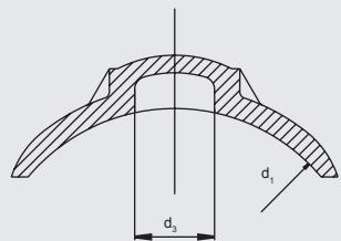
Для адаптации к трубам всех диаметров указанного диапазона с помощью прижимного приспособления FRIALEN FRIATOP (см. прайс-лист на приборы и технику FRIATOOLS). ПЭ-ВП седловина для ремонта небольших повреждений труб с и без выхода среды. Для предотвращения выхода среды должна применяться отдельная пробка\* ( $\leq d_3$ ). С открытым нагревательным элементом для оптимальной теплопередачи.
