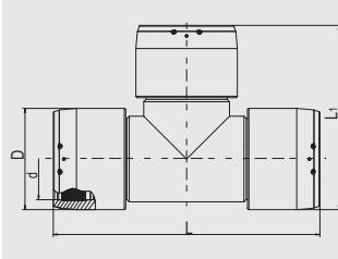
Имеют открытую нагревательную спираль для оптимальной теплопередачи на всех 3 выходах, большую глубину сопряжения, особо широкую зону сварки, холодные зоны по бокам и в центре, предотвращающие вытекание расплавленной массы, не требуют при работе специальных позиционеров и приспособлений. Раздельные сварочные зоны.
