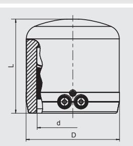
Имеет открытую нагревательную спираль для оптимальной теплопередачи, большую глубину сопряжения, особо широкую зону сварки, холодную зону на торце, предотвращающую вытекание расплавленной массы.
