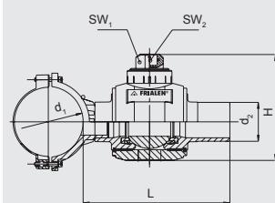
Компактное изделие из ПЭ-ВП. Это комбинация из FRIALEN - седловины и FRIALEN - шарового крана для экономящего место и стоимость горизонтального монтажа, специально для врезки. Служит для врезки в действующие трубопроводы с давлением до 10 бар (газ) и 16 бар (вода) с помощью приспособления для врезки. Имеет открытый нагревательный элемент для оптимальной теплопередачи. Сертифицировано DVGW, рег. Nr. DG-8631AU2252, DG-8631AU2253.
