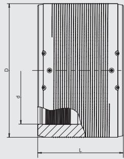
С открытой нагревательной спиралью для оптимальной передачи тепла, большая глубина вставки, широкие сварные зоны, широкие холодные зоны на концах и в середине для удержания давления расплава, монтаж возможен без дополнительных устройств. С индикаторами для визуального контроля сварки.
