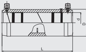
Муфты надежность-ПЛЮС, имеющие много плюсов в отношении безопасности. Имеют открытую нагревательную спираль для оптимальной теплопередачи, особо большую глубину сопряжения, особо широкую зону сварки, особо большие холодные зоны по бокам и в центре, обеспечивают оптимальное сопряжение с трубами с изогнутыми концами (из бухт), не требуют при работе специальных позиционеров и приспособлений.
