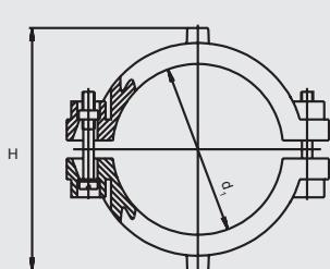
Компактное изделие из двух ПЭ-ВП седловин для ремонта небольших повреждений труб **без** утечки транспортируемой среды. С открытым нагревательным элементом для оптимальной теплопередачи.
