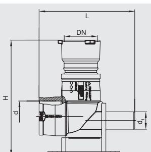
Для присоединения гидранта, имеющего на конце байонетное крепление типа BAIO, как алтернатива фланцевому соединению. Компактная деталь, состоящая из отвода FRIALEN 90° с подпятником (сравни с WF 90°) и байонетной муфты типа BAIO из ковкого чугуна с уплотнением. Литая муфта BAIO закреплена в полиэтилене неразъемно и неподвижно. Просьба следовать инструкции по монтажу для соединительной системы "BAIO". Для подземного гидранта необходимы защита насадок BAIO от грязи и скручивания.
