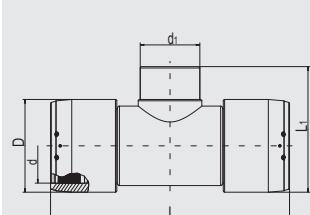
Имеют открытую нагревательную спираль для оптимальной теплопередачи, большую глубину сопряжения, особо широкую зону сварки, холодные зоны по бокам и в центре, предотвращающие вытекание расплавленной массы, не требуют при работе специальных позиционеров и приспособлений. Раздельные зоны сварки. Отводные патрубки SDR11 для приварки муфтами UB/MB. Другие диаметры выходных патрубков можно получить с помощью редукционных муфт MR d225/160, MR 110/90 или MR 110/63.
