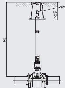
Телескопическая приводная штанга для управления FRIALOC – запорной арматуры из ПЭ для использования с ковером. Оптимально подогнаны друг к другу. В заданной области (RD) бесступенчатая установка по высоте. Простой монтаж посредством применения фиксирующей защелки. Исполнение- из оцинкованной или нержавеющей стали.
