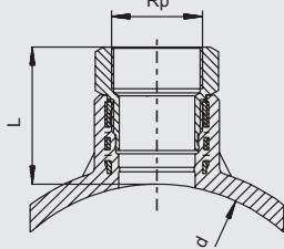
Применяется для адаптации ко **всем** диаметрам труб в заданной области с помощью прижимного приспособления FRIALEN FRIATOP (см. прайс-лист на приборы и технику FRIATOOLS). Компактное изделие. Представляет собой седловину из ПЭ-ВП с открытым нагревательным элементом для оптимальной теплопередачи. Переход ПЭ-ВП/красное литье является неразъемным и надежно застопорен в ПЭ-ВП от проворачивания. Служит для присоединения обычных латунных вентилей.
