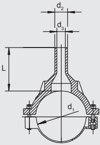
Компактное изделие из ПЭ-ВП седловины с открытым нагревательным элементом для оптимальной теплопередачи и выходным патрубком для монтажа вместе с FRIALEN - муфтами типа MB или UB. Врезка выполняется в безнапорном состоянии с помощью подходящего приспособления для врезки.
