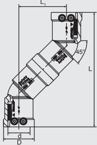
Компактное изделие для соединения трубопроводов, не параллельно стыкующихся друг с другом, а также для соединения домового ввода с арматурой для врезки под давлением DAA или DAV при параллельной прокладке второй магистрали с одинаковой глубиной укладки и цокольного ввода.
