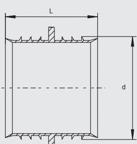
Для ремонта в безнапорном состоянии домовых вводов водопроводов. Предотвращает попадание воды в сварную зону FRIALEN - муфт типа MB и UB.
