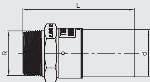
Компактное изделие. Полиэтиленовая часть дает возможность производить монтаж вне зависимости от положения и обеспечивает герметичное сварное соединение со всеми подходящими фасонными изделиями FRIALEN. Латунная часть неразъемна и надежно без возможности проворачивания соединена с полиэтиленовой. Сертифицировано DVGW, Рег.-Нр. DV-7501AU2256, DV-7501AU2257.
