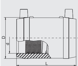
Применяются также как ремонтные муфты. Имеют открытую нагревательную спираль для оптимальной теплопередачи, большую глубину сопряжения, особо широкую зону сварки, холодные зоны по бокам и в центре, предотвращающие вытекание расплавленной массы, не требуют при работе специальных позиционеров и приспособлений.
