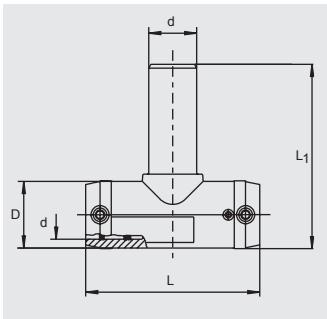
Прямой проход имеет открытую нагревательную спираль для оптимальной теплоотдачи, большую глубину сопряжения, особо широкую зону сварки, а также предотвращающие вытекание расплавленной массы холодные зоны сварки на торцах и в середине для сварки без позиционеров. Удлиненный отводной патрубок рассчитан на 2 сварки.
