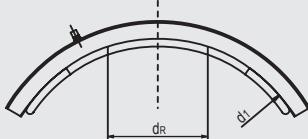
Компактное изделие из ПЭ-ВП для ремонта таких повреждений, как царапины, канавки или проникновения трубы. Накладка с открытой нагревательной спиралью для оптимальной теплопередачи. Для монтажа с помощью монтажного приспособления VACUSET XL (см. прайс-лист на приборы и технику FRIATOOLS). С жидкостными индикаторами для визуального контроля процесса сварки.
