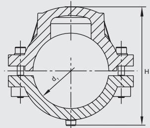
Компактное изделие из двух ПЭ-ВП седловин для ремонта небольших повреждений труб **с** и **без** выхода транспортируемой среды. Для предотвращения попадания транспортируемой среды в зону сварки, поврежденное место глушится дополнительной пробкой\* ( $\leq d_3$ ). С открытым нагревательным элементом для оптимальной теплопередачи.
