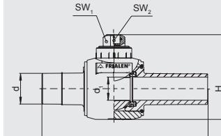
Компактное изделие из ПЭ-ВП, привариваемое в процессе монтажа FRIALEN - муфтами MB или UB. Проход крана соответствует внутреннему диаметру трубы. Не требуется мероприятий по защите от коррозии. Открытое и закрытое положения определяются упорами. Запорный кран, не требующий технического обслуживания, управляет с помощью штанги (например FRIALEN - BS). Сертифицировано DVGW, рег. Nr. DG-8631AU2251, DG-8631AU2252.
