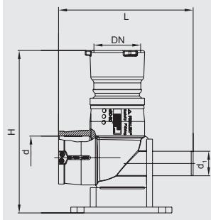
Для подключения гидранта с литым чугунным концом. Компактная деталь, состоящая из отвода FRIALEN 90° с под пятником (сравни с WF 90°) и муфтового соединения типа NOVO-SIT из ковкого чугуна с уплотнением типа Tylon и NOVO-SIT кольца для обеспечения надежности присоединения. Литая муфта NOVO-SIT закреплена в полиэтилене неразъемно и неподвижно. Просим следовать инструкциям по монтажу для соединительной системы NOVO-SIT.
