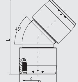
Имеют открытую нагревательную спираль для оптимальной теплопередачи, большую глубину сопряжения, особо широкую зону сварки, холодные зоны по бокам и в центре, предотвращающие вытекание расплавленной массы, не требуют при работе специальных позиционеров и приспособлений. Раздельные сварочные зоны.
