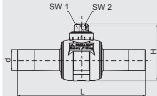
Компактное изделие из ПЭ-ВП, привариваемое в процессе монтажа FRIALEN - муфтами MB или UB. Не требуется мероприятий по защите от коррозии. Открытое и закрытое положения определяются упорами. Запорный кран, не требующий технического обслуживания, управляет с помощью штанги (например FRIALEN - BS). Сертифицировано DVGW, рег. Nr. DG-8631AU2251, DG-8631AU2252 и DG-8631AU2253.
