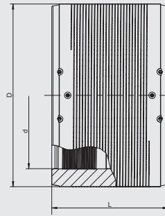
Предназначены для перехода со стандартной трубы на трубу для релайнинга. Имеют открытую нагревательную спираль для оптимальной теплопередачи, большую глубину сопряжения, особо широкую зону сварки, холодные зоны по бокам и в центре. С раздельными сварными зонами. Уменьшение зазора между трубой и муфтой при монтаже возможно при применении технологии предварительного прогрева. См. руководство по монтажу для муфт для релайнинга.
