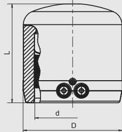
Имеет открытую нагревательную спираль для оптимальной теплопередачи, большую глубину сопряжения, особо широкую зону сварки, холодную зону на торце, предотвращающую вытекание расплавленной массы. Начиная с d 180 имеют жидкостные индикаторы для визуального контроля процесса сварки.
