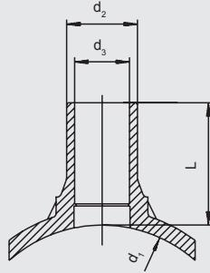
Для адаптации к трубам **всех** диаметров в заданной области с помощью прижимного приспособления FRIALEN FRIATOP (см. прайс-лист на приборы и технику FRIATOOLS). Компактное изделие из седловидной формы из ПЭ-ВП с открытым нагревательным элементом для оптимальной теплопередачи и выходным патрубком для FRIALEN - муфт типа MB или UB. Врезка без стружки в безнапорном состоянии с использованием обычных для этих целей приспособлений.
