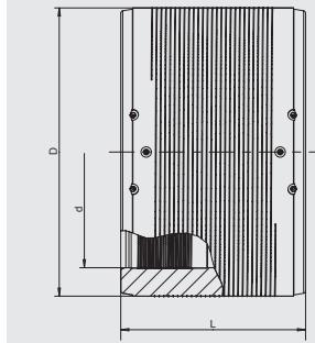
Имеет открытую нагревательную спираль для оптимальной теплопередачи, большую глубину сопряжения, особо широкую зону сварки, холодные зоны по бокам и в центре, предотвращающие вытекание расплавленной массы, не требуют при работе специальных держателей и приспособлений. С жидкостными индикаторами для визуального контроля процесса сварки.
