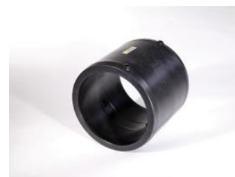
Муфта электросварная PE 100-RC Рабочее давление: вода 16 бар/ газ 10 бар Электромуфтовая сварка
