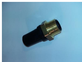
Переход ПЭ/латунь, с наружной резьбой PE 100
